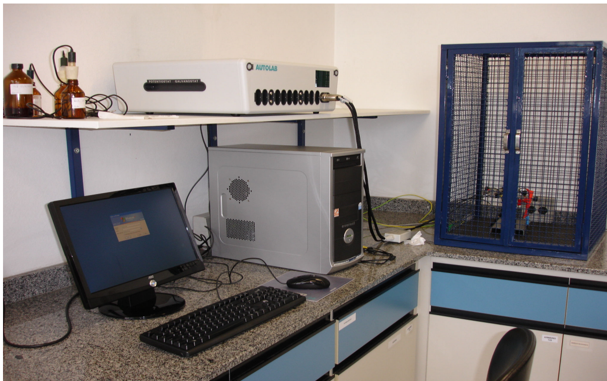
FIGURA 7 – Potenciostato-Galvanostato, acoplado a um computador e a uma gaiola de Faraday, utilizados nos experimentos eletroquímicos.
