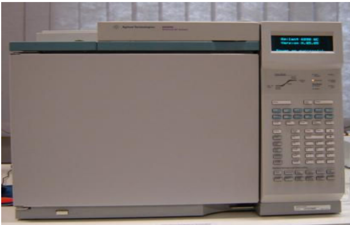
FIGURA 10 – Cromatógrafo gasoso, utilizado nos ensaios de gorduras saturadas, monoinsaturadas, polinsaturadas, trans e fitosteróis.
