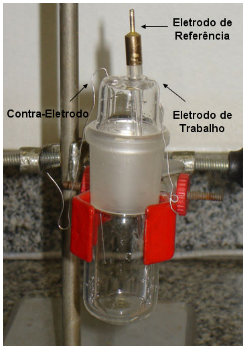
FIGURA 8 – Célula eletroquímica e eletrodos utilizados nos experimentos eletroquímicos.
