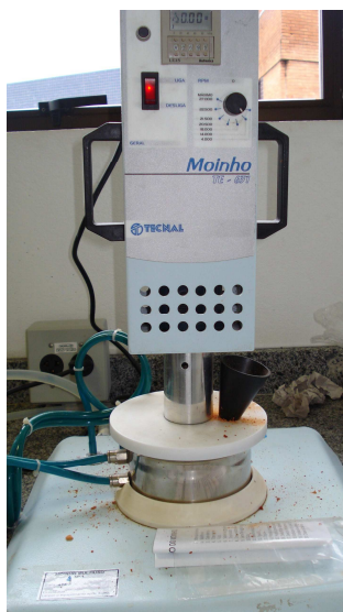
FIGURA 14 - Moinho de faca utilizado para obtenção dos pós (farinhas) de vegetais. Fonte: Zanatta, dados da pesquisa (2009).
