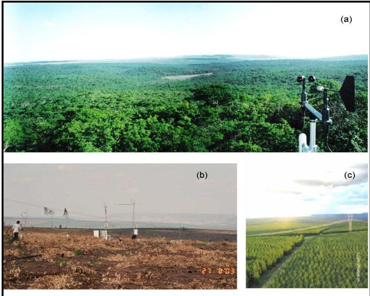
Figura 4.4. **(a)** Vista da Gleba Pé de Gigante na direção sudeste, de visada do topo da torre de 21 m, com anemômetro convencional ao lado; **(b)** Sistema de eddy-covariance com 3m de altura sobre Eucalipto (em 27/08/2003) após a colheita e **(c)** Torre de fluxos sobre plantação de eucalipto (Janeiro 2005), no lado inferior da foto, com Linha de energia no lado superior, na Fazenda Cara Preta. (Fotos: Laboratório de Clima e Biosfera, IAG/USP).
