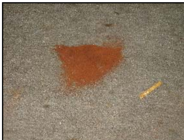
Figura 19- Ferrugem das latas em contato com o carpete (piso do acervo)
