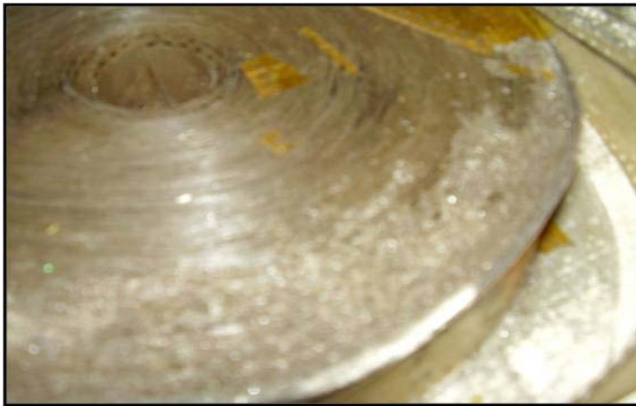
Figura 15- Reticulação por cristalização, encolhimento, abaulamento e excesso de umidade
