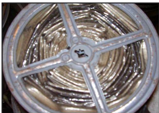
Figura 11- Ressecamento, abaulamento e encolhimento
