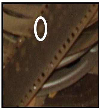
Figura 24- Colônia de fungo presente na emulsão nas imagens I e II
