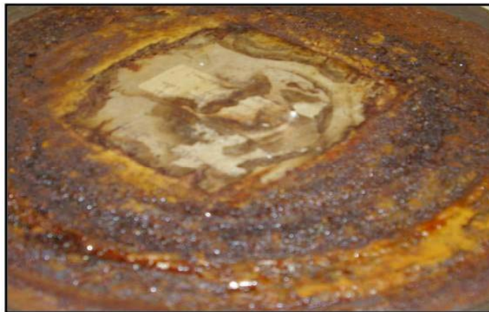
Figura 16- Estojo enferrujado acelera o processo de deterioração
