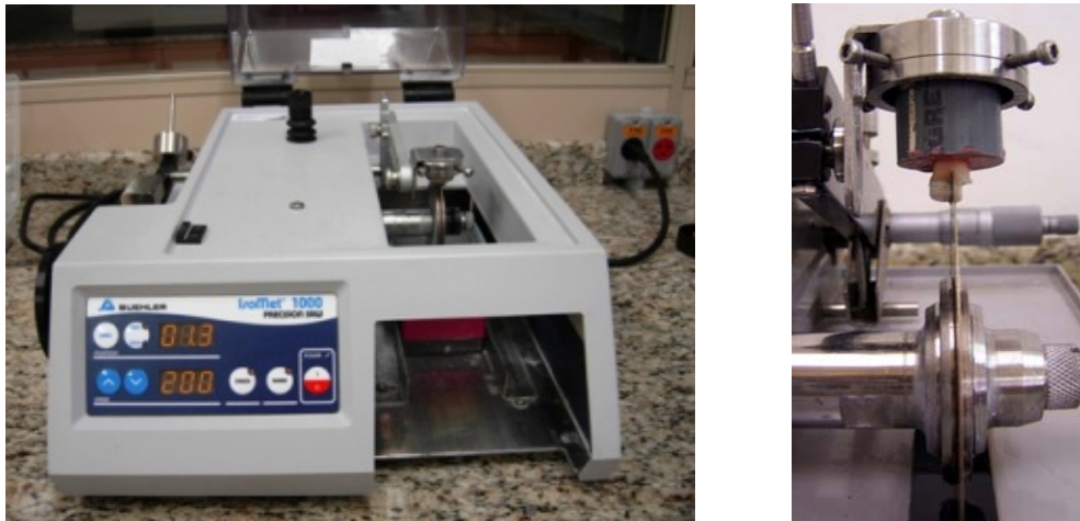
Figura 4.4 – Corte dos dentes para obtenção dos corpos de prova em forma de palitos
