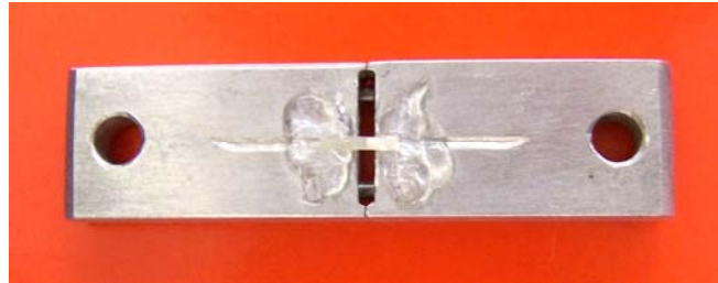
Figura 4.5 – Corpo de prova obtido no corte do dente colado no jig de Geraldeli
