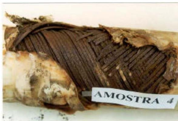
Figura 9: Ruptura generalizada de arames da armadura de tração e corrosão avançada de arames (COSTA , 2002).
