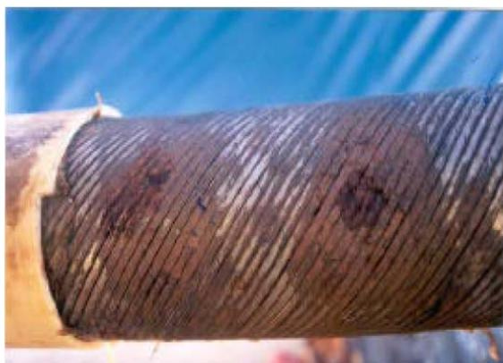
Figura 8 : Corrosão de arames da armadura de tração e desgaste da capa externa (COSTA , 2002).
