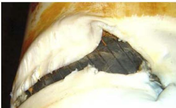
Figura 4: Dano (rasgo ou corte) da capa externa gerada pela entrada do Bend Stiffener no I-tube (MARINHO *et al.*, 2006).
