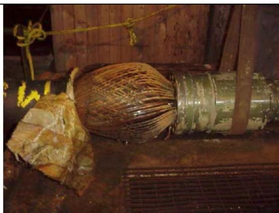
Figura 11: Instabilidade estrutural (“Gaiola de Passarinho”).
