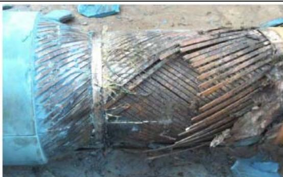
Figura 10: Ruptura generalizada de arames da armadura de tração na seção de topo (SIMÕES *et al.*, 2003).
