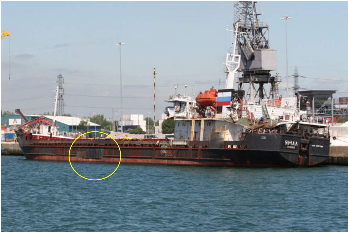
Figura 30: N/M Yamal (18/06/05) com tamponamento de aço no casco [Ref. 34 – Shipspotting]
