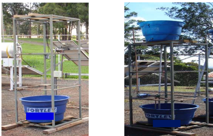
Figura 40 – Estrutura metálica de sustentação do Sistema Sp.
