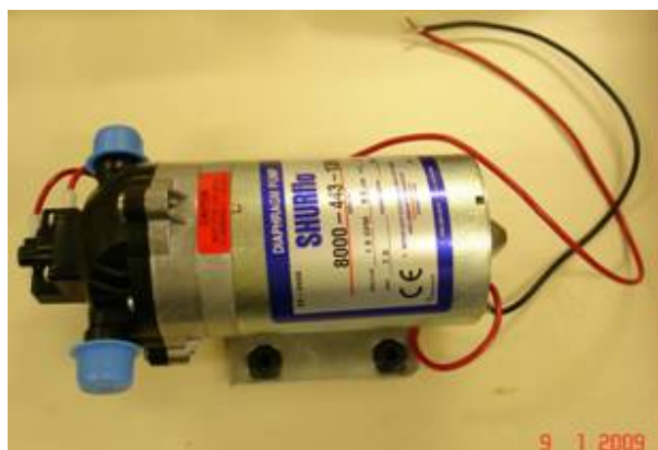
Figura 18 – Exemplo de uma bomba de diafragma.
