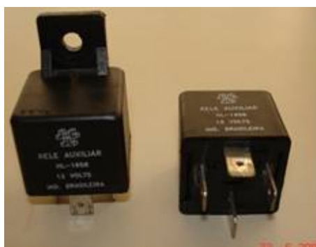
Figura 36 – Relé automotivo de 12 VCC.
