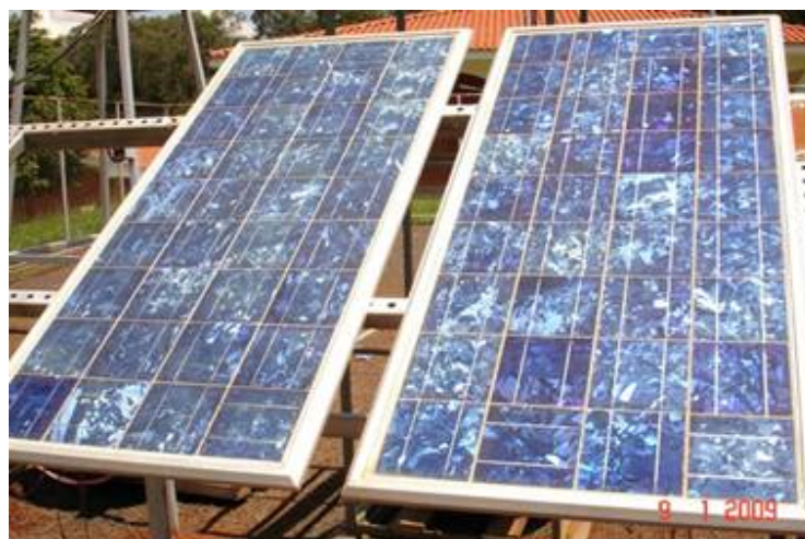
Figura 41 – Painéis solares fotovoltaicos policristalinos.
