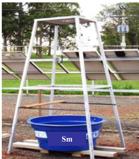
Figura 29 – Estrutura metálica para Sistema Sm.
