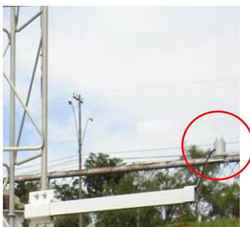
Figura 24 – Piranômetro no plano horizontal.
