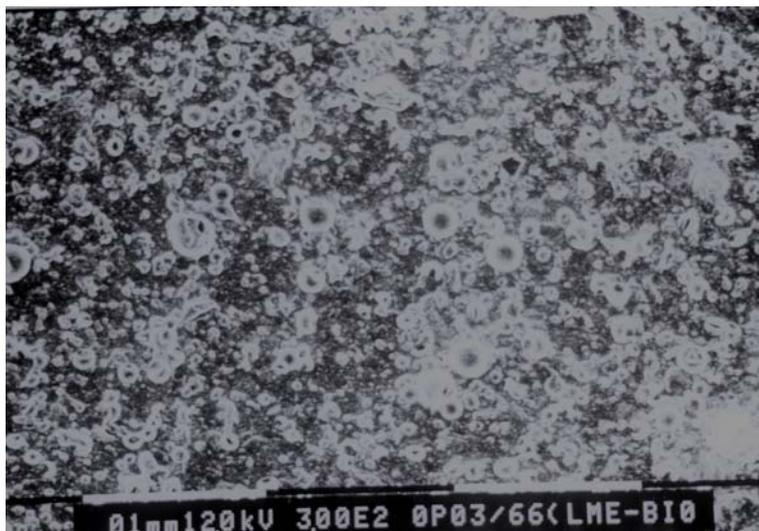
**Figura 27.** Solução concentrada de Demand 2,5 CS no azulejo. Microscopia eletrônica de varredura, aumento 720X.
