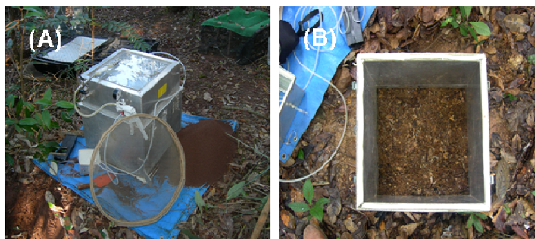
Figura 10 - (A) câmara de respiração do solo, e (B) câmara de respiração do solo sem serapilheira.
