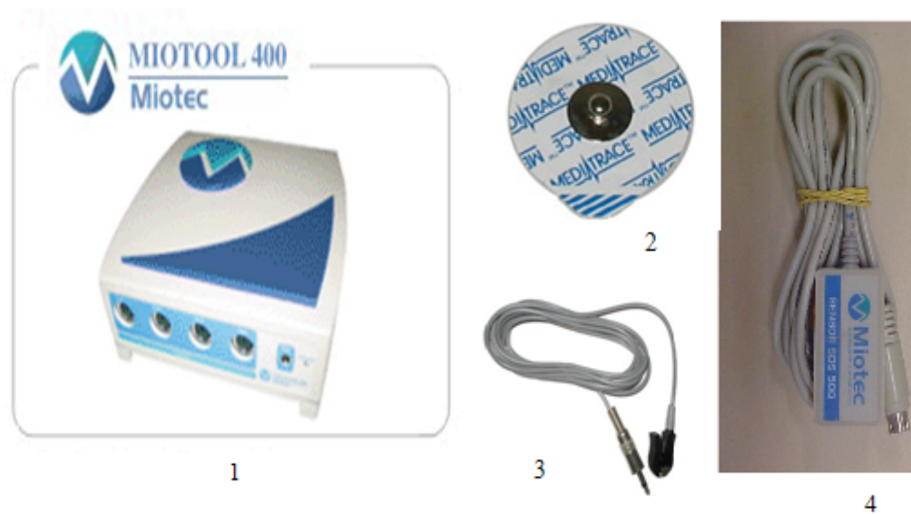
Figura 4 – Miotool 400 USB (1), eletrodo Meditrace Kendall 200 (2), cabo de referência (3), sensor diferencial SDS – 500 (4).
