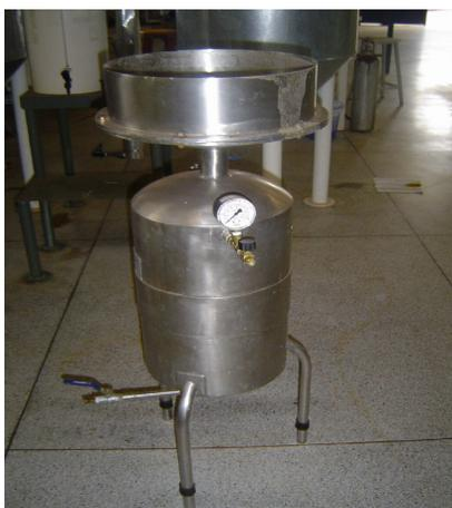
**Figura 8.** Filtro à vácuo utilizado no processo.
