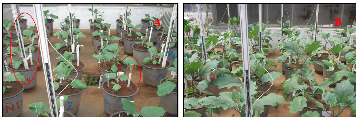
Figura 3. Tensímetros e tensiômetros instalados no experimento (Figura A e B).
