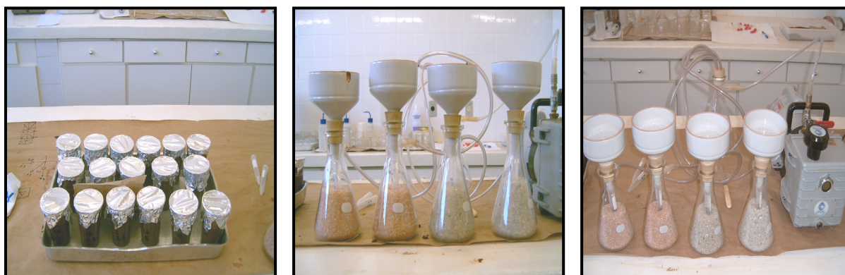
Figura 5. Materiais utilizados para a determinação da curva de salinização pelo método de pasta saturada.
