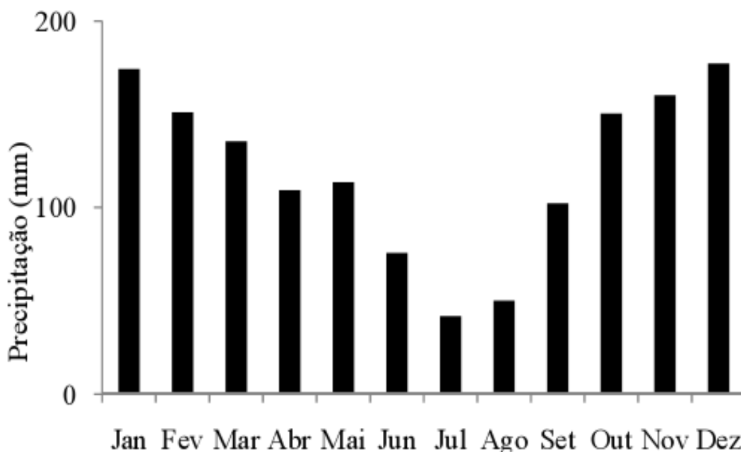
FIGURA 7- Precipitação média mensal na área de drenagem da Bacia Hidrográfica do Rio Dourados, considerando o período de 1958 a 2007 (ARAI et al., 2009).
