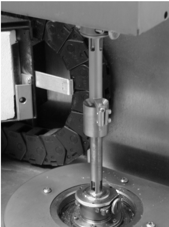
Figura 3.3: Dispositivo proposto utilizando uma combinação entre as geometrias Couette e Film Tension .
