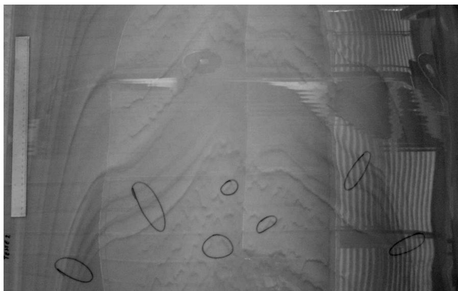
Figura 4.48: Chapa manufaturada durante os testes COEX 03. Pode-se ver as marcas deixadas pelas instabilidades do tipo onda e zigue-zague
