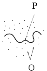
Figura 2.4: A cadeia P move-se entre os obstáculos fixos, O, mas não pode cruzá-los (Adaptado de De Gennes , 1971).
