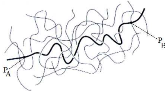
Figura 2.6: Cadeia polimérica na rede de entrelaçamentos (Adaptado de Carreau, 1997).
