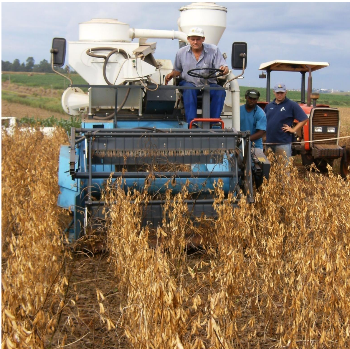
Figura 6. Colheita da soja nas parcelas experimentais com colhedora desenvolvida para essa finalidade. Botucatu, SP. 2009.
