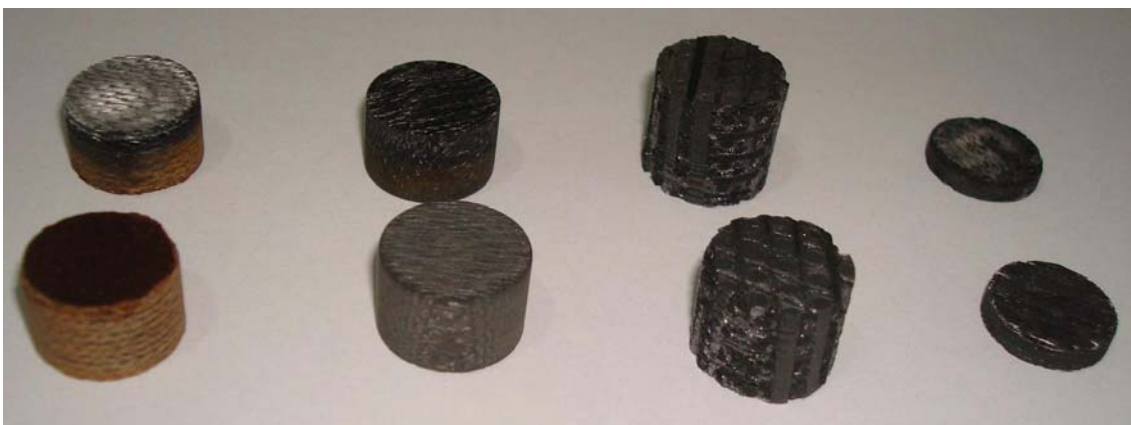
Figura 5.6 – Imagem de amostras dos materiais ensaiados, abaixo amostras antes dos ensaios e acima amostras após ensaios.
