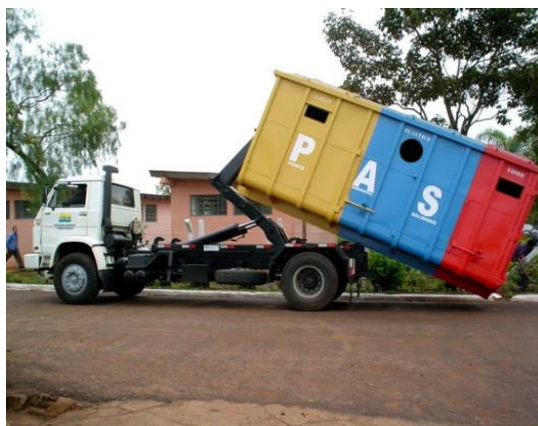
Figura 13: Veículo utilizado na coleta seletiva, equipado com o sistema roll-on roll off com a caçamba que recebe os materiais coletados pelos cooperados com o carrinho
