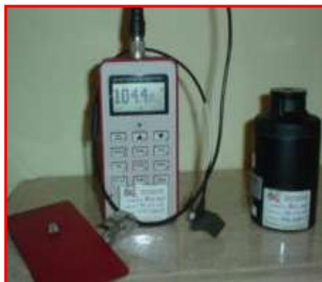
Figura 37 – Audiodosímetro de ruído para avaliação do NPS de campo no interior da cabina
