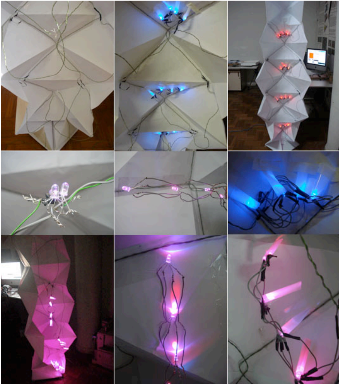
FIGURA 42 – [Imagens de inserção dos leds RGB e da fiação no interior do origami. Parte do Estudo experimental 3, desenvolvido pela autora e pelos bolsistas de iniciação científica do LAGEAR em 2009]
