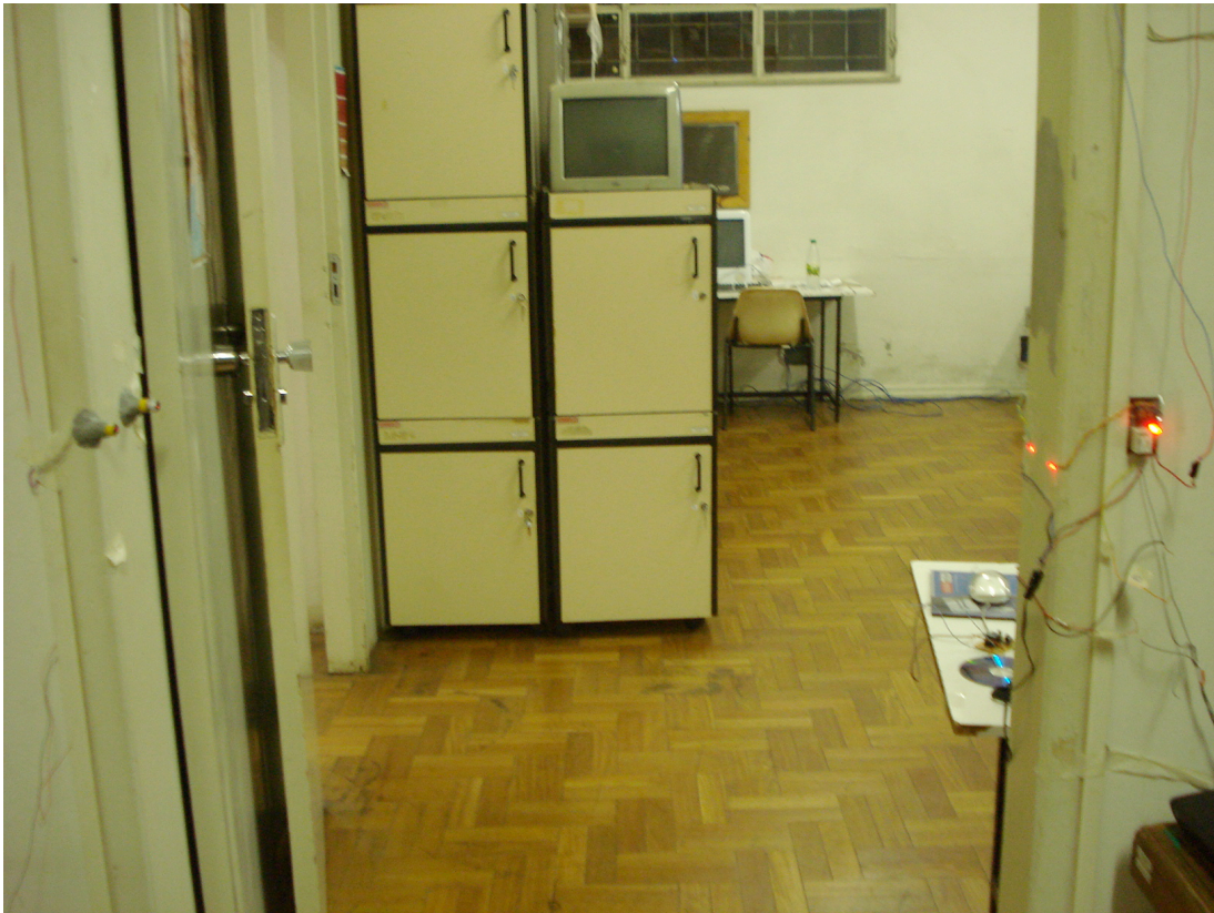
FIGURA 29 – [Foto dos diodos de laser e sensores de luz, mostrando a configuração real do esquema anterior: dois sensores e dois fechos de laser dispostos paralelamente no vão da porta do LAGEAR. Parte do Estudo experimental 3, desenvolvido pela autora e pelos bolsistas de iniciação científica do LAGEAR em 2009] Fonte: imagem produzida pela autora.
