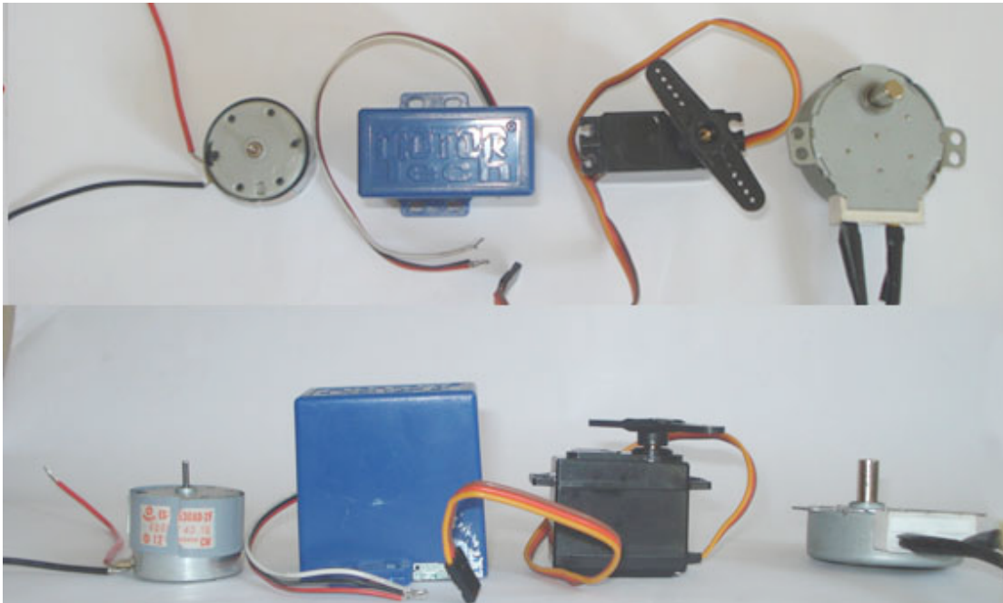
FIGURA 38 – [Imagem dos motores testados que não funcionaram. Da esquerda para a direita: motor DC, motor servo de baixo torque, motor servo de alto torque, e motor de microondas. Parte do Estudo experimental 3, desenvolvido pela autora e pelos bolsistas de iniciação científica do LAGEAR em 2009]
