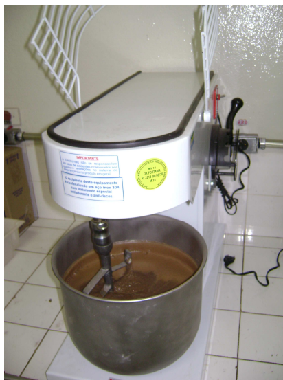
Figura 8. Batedeira industrial utilizada para homogeneizar a contaminação de Cu no solo.
