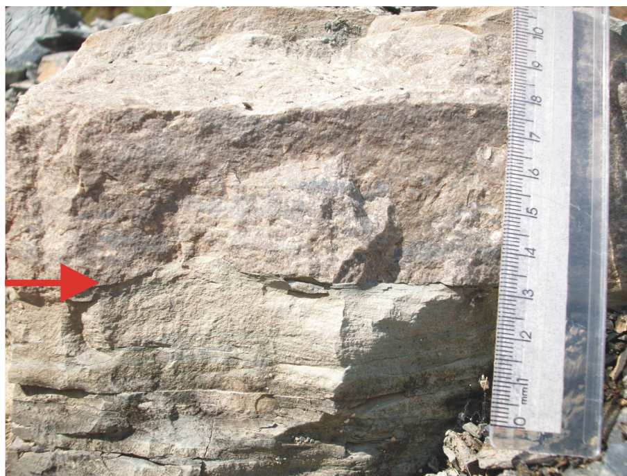
Figura 3.11 - Camada carbonática conchífera da pedreira PRU 2 de Prudentópolis, havendo contato inferior com superfície de erosão (seta).
