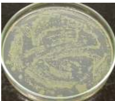
Figura V.13. Plaqueamento do filtro CAG alimentado pelo efluente bruto (sem diluição)
