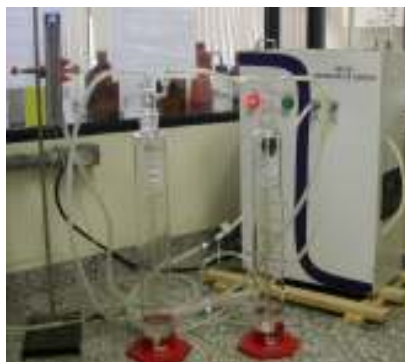
Figura IV.10. Arranjo dos reatores com iodeto de potássio, em série
