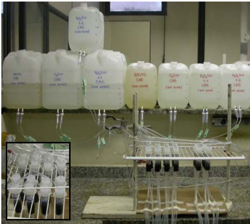
Figura IV.7. Unidade experimental de carvão ativado: reservatórios CAG e CAB e filtros CAG e CAB. Em detalhe, uma aproximação dos filtros.
