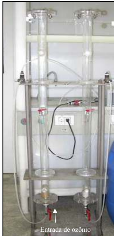
Figura IV.5. Reator B utilizado para ensaios de ozonização
