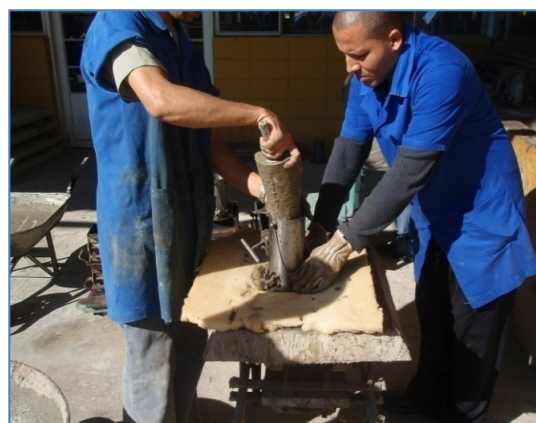
Figura 7-4- Concretagem dos CPs cilíndricos
