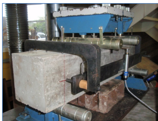
Figura 7-12 – Ensaio estático para a determinação do módulo de elasticidade – prisma 15x15x75cm
