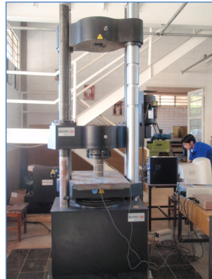
Figura 7-7 – Ensaio estático de um CP cilíndrico na Instron
