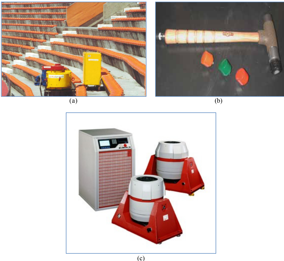
Figura 4-11 – Excitadores : (a) Excitador rotativo de massa (JULIANI,2009); (b) Martelo de Impacto, Endeveco 2303 (ALMEIDA, 2005); (c) Excitador eletro-dinâmico (fonte: B&K).
