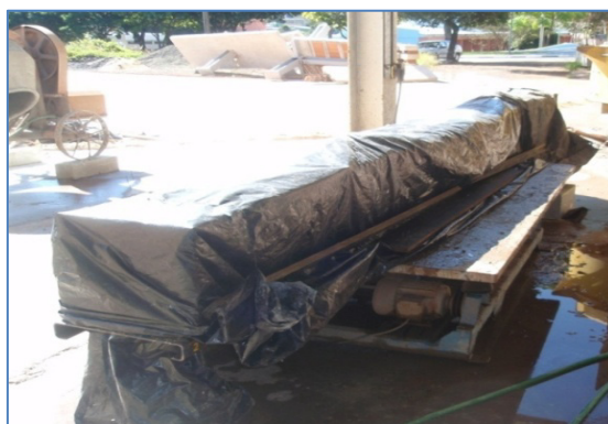
Figura 7-23 – Procedimento utilizado para cura do modelo
