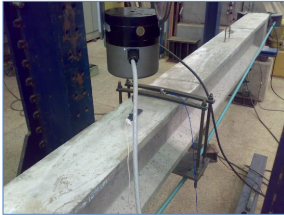
Figura 7-38 – Esquema de excitação do modelo com shaker
