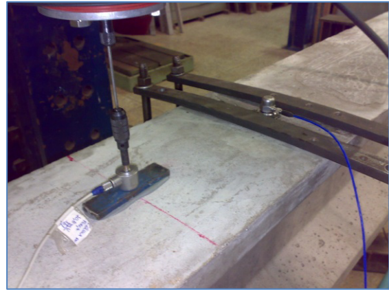
Figura 7-39 – Detalhe do posicionamento do shaker + célula de carga e acelerômetro
