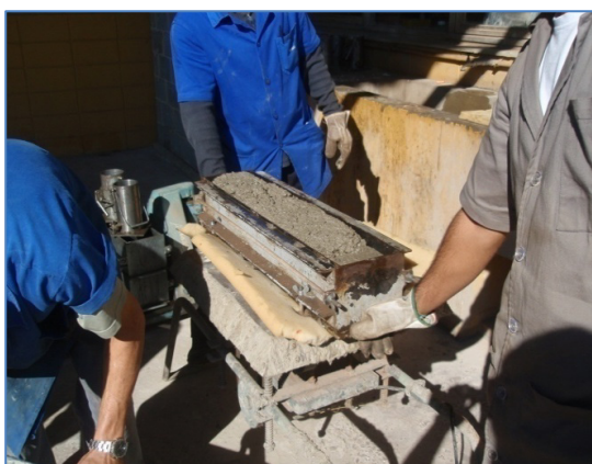
Figura 7-3 – Concretagem dos CPs prismáticos
