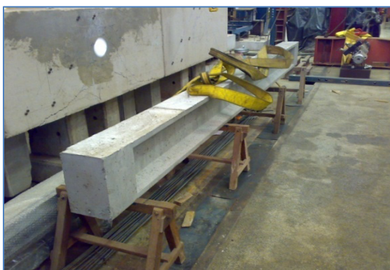
Figura 7-22 – Desforma do modelo após 48 horas
