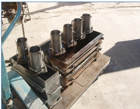
Figura 7-1 – Fôrmas metálicas dos CPs
