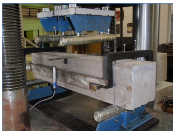
Figura 7-11 – Dispositivo de flexão por quatro pontos – prismas – Módulo Estático
