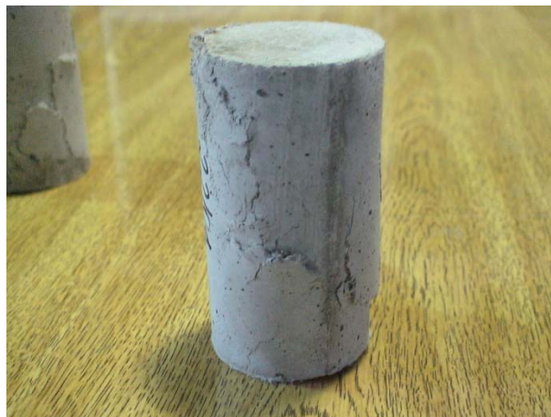
Figura 5.2 - Corpo-de-prova PP12 após ensaio de compressão simples
