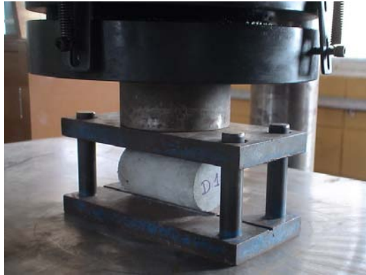
Figura 4.10 - Esquema de ensaio de tração por compressão diametral
