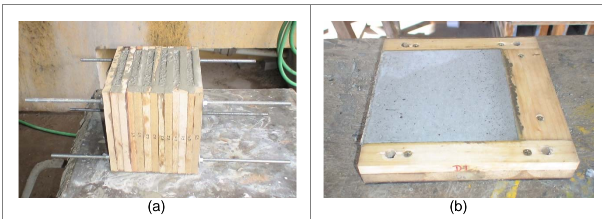
Figura 4.13 - (a) Placas na bateria após a moldagem; (b) Placa sendo desmoldada
