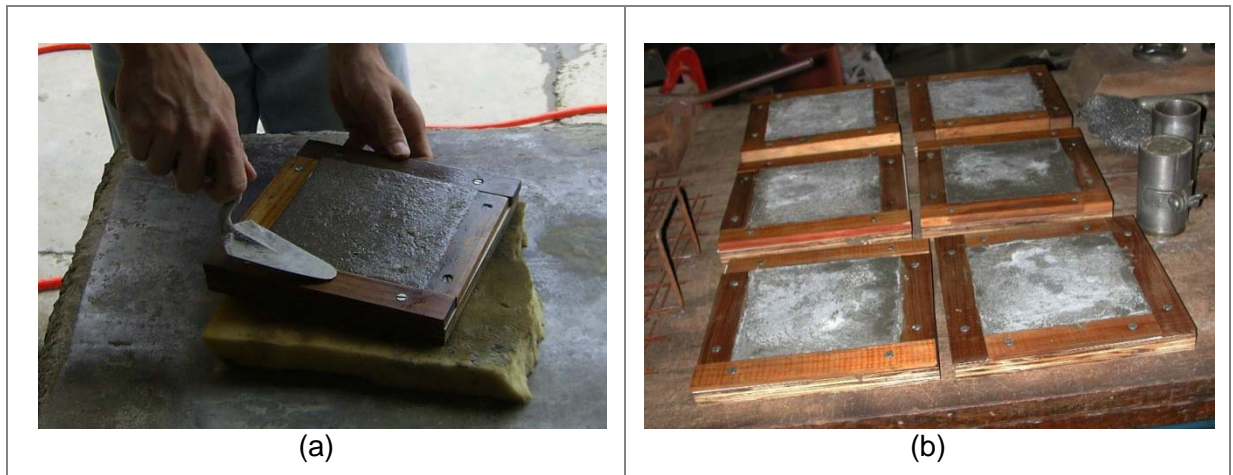
Figura 4.2 - Placas moldadas em fôrmas sem controle de uma das superfícies
