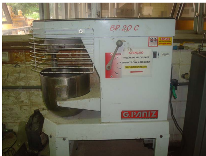
Figura 4.1 - Batedeira Industrial utilizada na mistura da argamassa
