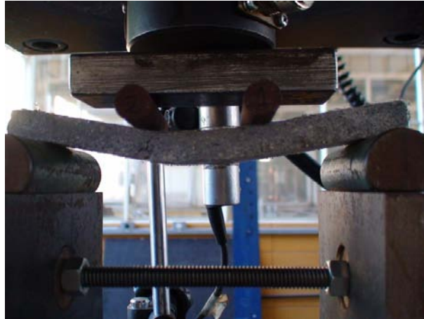
Figura 5.24 – Foto do ensaio de flexão
