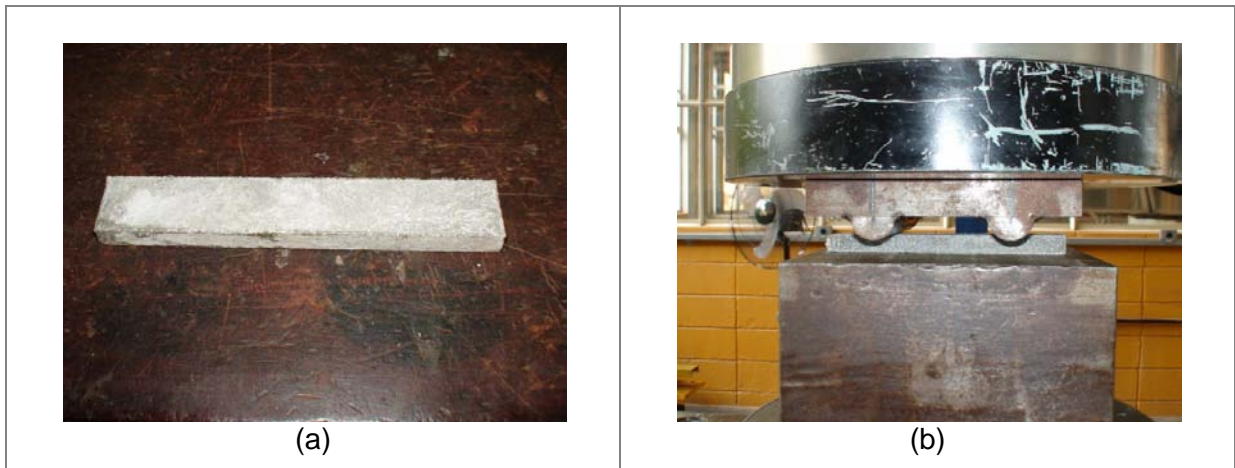
Figura 4.16 - (a) Amostra para o ensaio de força concentrada; (b) Esquema do ensaio de força concentrada
