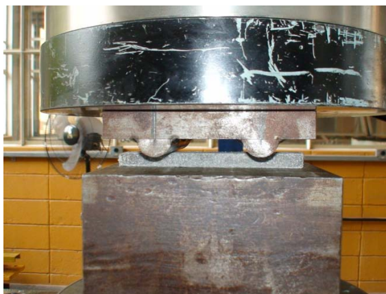
Figura 2.11 - Esquema de ensaio de afundamento (MONTEDOR, 2004)
