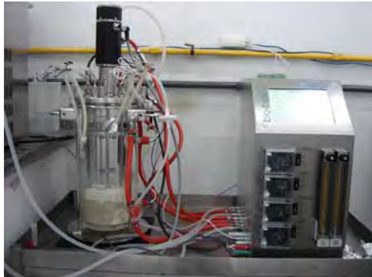
Figura 25: Fermentador (Bio T mini – ZETA): Condições de cultivo: 40°C, 300 rpm, 180 L/ar/hora, 2% inoculo, 2 L de meio de cultura, 1% penas inteiras, 72 h.
