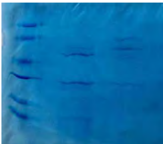
Figura 11: Perfil eletroforético em SDS PAGE gradiente de 10 a 20 % de acrilamida -. Linha 1: Padrões de proteínas (de cima para baixo): fosforilase, albumina de soro bovino, ovoalbumina, anidrase carbônica, inibidor de tripsina, \alpha lactalbumina. Linha 2: Fração1, Linha 3: Fração2, ambas as frações eluídas da coluna DEAE Sephadex A 50.
