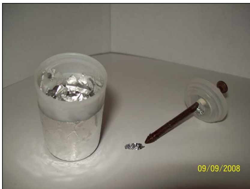
Garrafa de Leyden construída no laboratório pelos alunos
