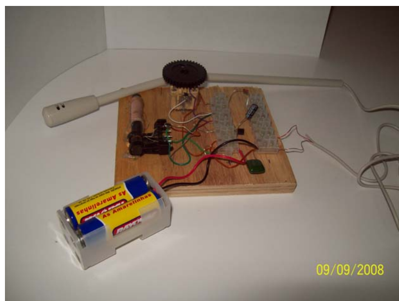
Transmissor construído, no detalhe, o microfone utilizado
