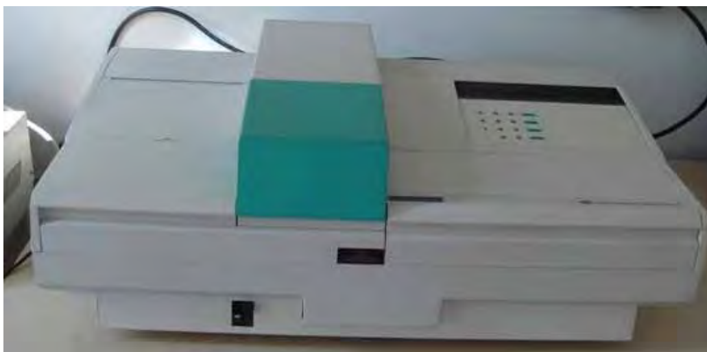
Figura 1- Bioscreen C, equipamento utilizado para medição de biomassa.
