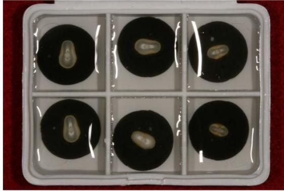
Figura 6 - Corpos de prova armazenados em água, dentro de caixa com divisões individualizadas.
