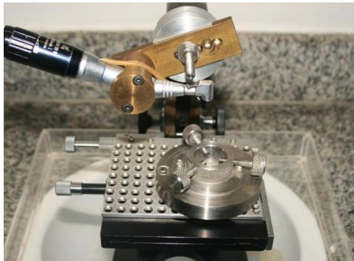
Figura 3 – Dispositivo para padronização do preparo do conduto.
