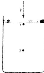
Fig.7-20: O aumento de pressão no ponto (1) é transmitido integralmente ao ponto (2).
