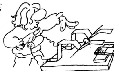
Para colocar o motor em funcionamento, não se esqueça que o esmalte do fio da bobina é isolante elétrico. Assim, você deve raspá-lo para que o contato elétrico seja possível. Além disso, em um dos lados você deve raspar só uma parte deixando uma parte ao longo do comprimento e não esqueça que esse motor precisa de um 'impulso' inicial para dar a partida.
