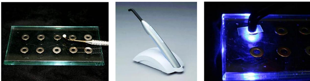
**FIGURA 3:** Matrizes sobre a placa de vidro, inserção da resina composta, aparelho Elipar FreeLight 2 e fotopolimerização.
