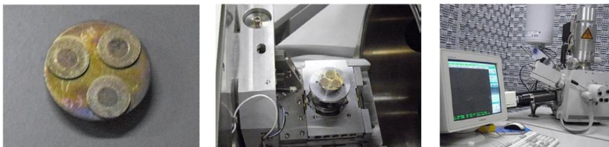
**FIGURA 5:** Amostras metalizadas e levadas ao MEV.
