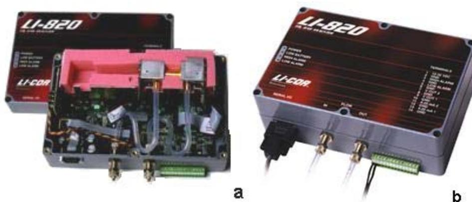
**Figura 3** – Aparência interna (a) e externa (b). LI – 820 CO<sub>2</sub> Gas Analyzer.
