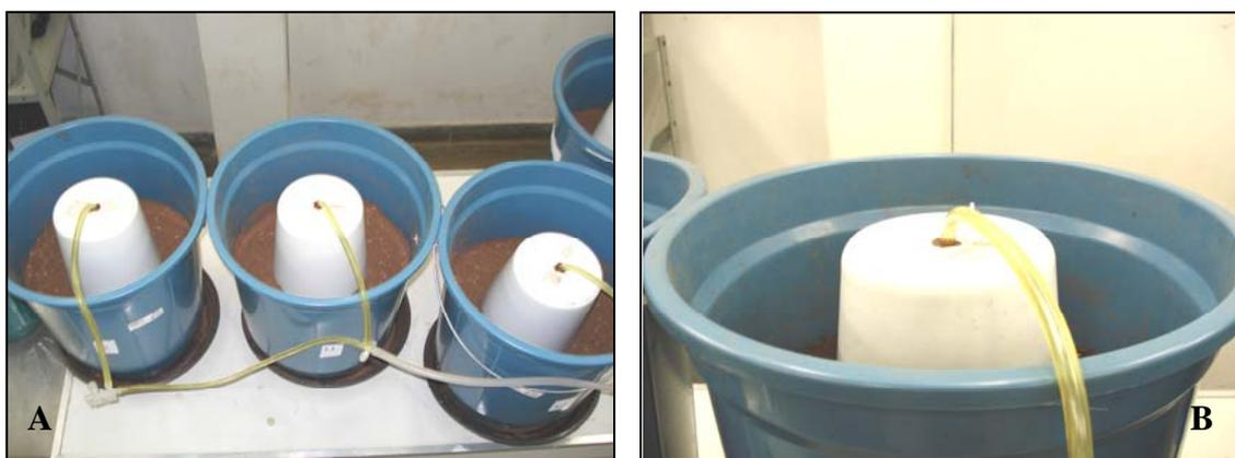
**Figura 4** – Reatores com as respectivas câmaras de armazenamento. A – reatores em triplicata; B – Detalhe de reator com câmara conectada a mangueira.
