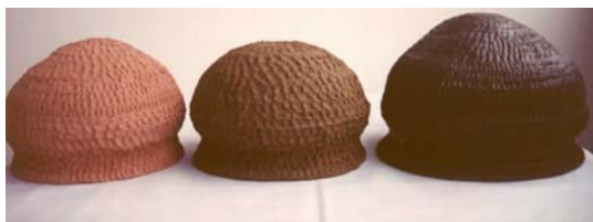
Fig.32 – Da esquerda para direita temos as peças, antes da queima, executadas com as amostras de: 1º Argila de papelaria em Chapecó – SC – P.Cco, 2º de Trindade do Sul – RS – P.EN4, 3º da Cerâmica Chapecó – Pcco3.
