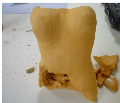
Fig.65. Peça danificada no processo de queima
