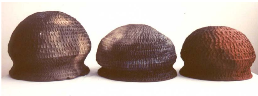
Fig. 42 Resultados da queima em forno a lenha: À esquerda a amostra de Terra Fraca - Município de Palhoça – SC, ao centro a amostra da Ind. Cerâmica Chapecó – e à direita a segunda amostra de Trindade do Sul.
