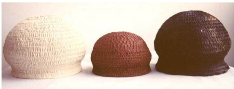
Fig.35 – À esquerda a amostra de São Paulo, queima em forno elétrico, com mudança de cor e contração de 4%. No centro a amostra de Trindade do Sul, mudança de cor e contração de 24% e inúmeras rachaduras. À direita a amostra de Palhoça, mudança de cor, contração 10%, pequena separação entre dois roletes da borda.
