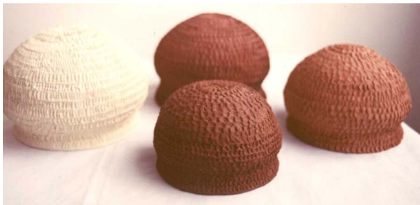
Fig. 40 Resultados da queima em forno elétrico. À esquerda a amostra de São Paulo, À direita A amostra de argila encontrada em papelarias de Chapecó, à frente a amostra de Trindade do Sul – RS, e ao fundo a amostra da Ind.Cerâmica Primavera de São Carlos – SC.
