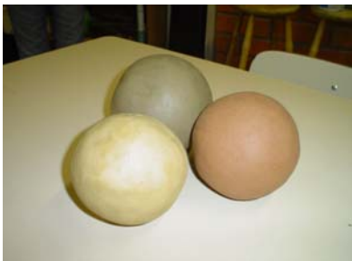
Fig.49. Confeção de esferas ocas com diferentes qualidades de argila para observação das qualidades de queima.
