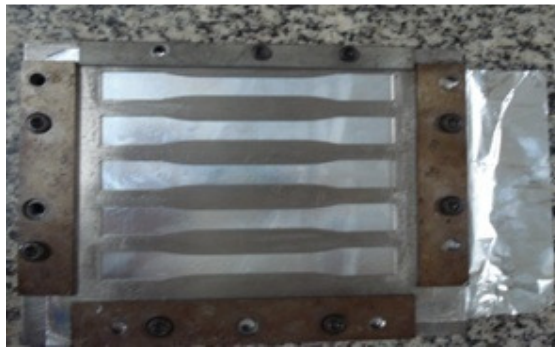
Figura 16: Molde utilizado para a preparação do corpo de prova para o ensaio de tração.
