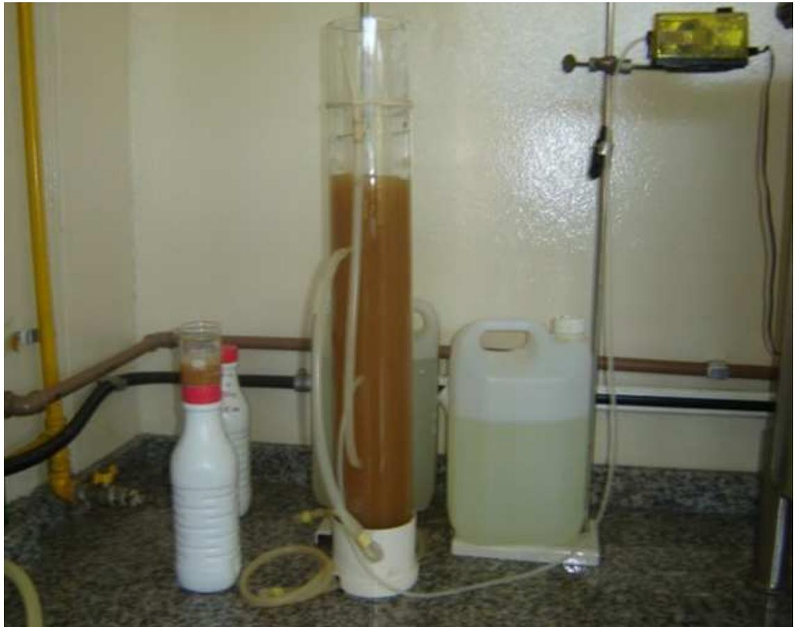
Figura 6: Reator em batelada sequencial tratando efluente sintético de laticínio.
