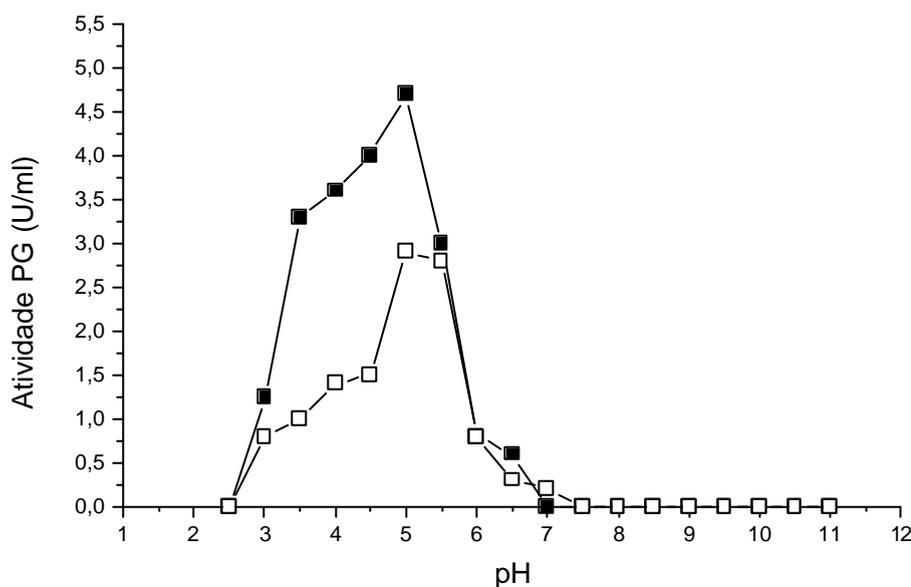
**Figura 8:** Efeito do pH sobre a atividade das pectinases brutas produzidas por *Thermoascus aurantiacus* em FES em meio de 30% de bagaço de cana e 70% de laranja e em FSM na água amarela. Tampões: acetato 2,5-5,5; citrato 5,5-7,0; tris-HCl 7,0-8,5; glicina 8,5-11,5. -FES; -?- FSM.
