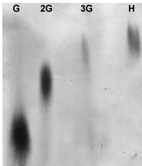
**Figura 23:** Produtos de hidrólise da atividade das poligalacturonases puras em ácido trigalacturônico (Sigma), após 10 min de incubação. Os produtos foram separados em papel Whatmman. 3G-ácido trigalacturônico; 2G- ácido digalacturônico; 1G- ácido galacturônico; H- hidrolisado.
