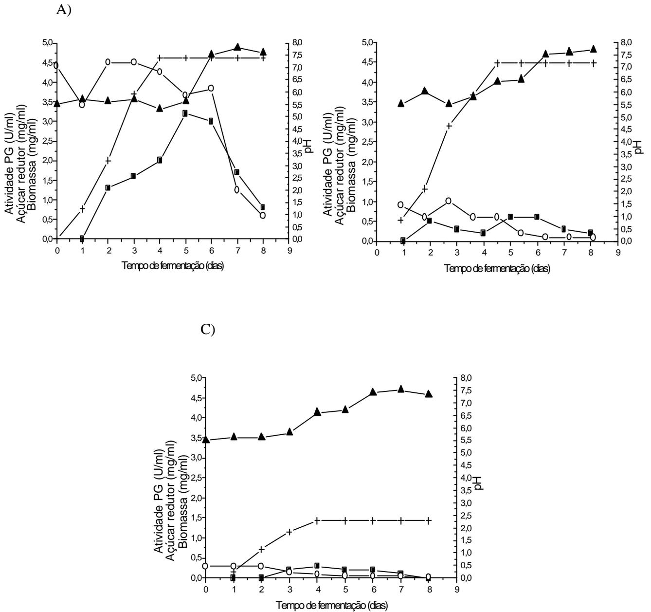
**Figura 6 :** Produção de poligalacturonase pelo fungo *Thermoascus aurantiacus* através da fermentação da água amarela. **A-** Sem diluição; **B-** Diluída 5x; **C-** Diluída 10x. -+ - Atividade de PG; -o- Açúcar redutor do meio do meio cultivo; -? - pH do meio de cultivo; +- Biomassa fúngica. Valores expressos como média dos três experimentos.
