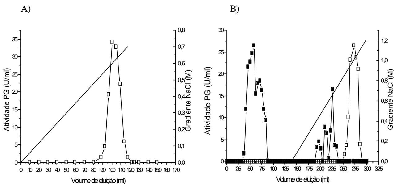
**Figura 13:** Perfil de eluição das poligalacturonases produzidas por *Thermoascus aurantiacus* aplicadas na coluna de cromatografia de troca iônica SP Sepharose. **A-** Fermentação Submersa (FSM); **B-** Fermentação em Estado Sólido (FES). -?- Atividade PG; -|- Proteínas totais.
