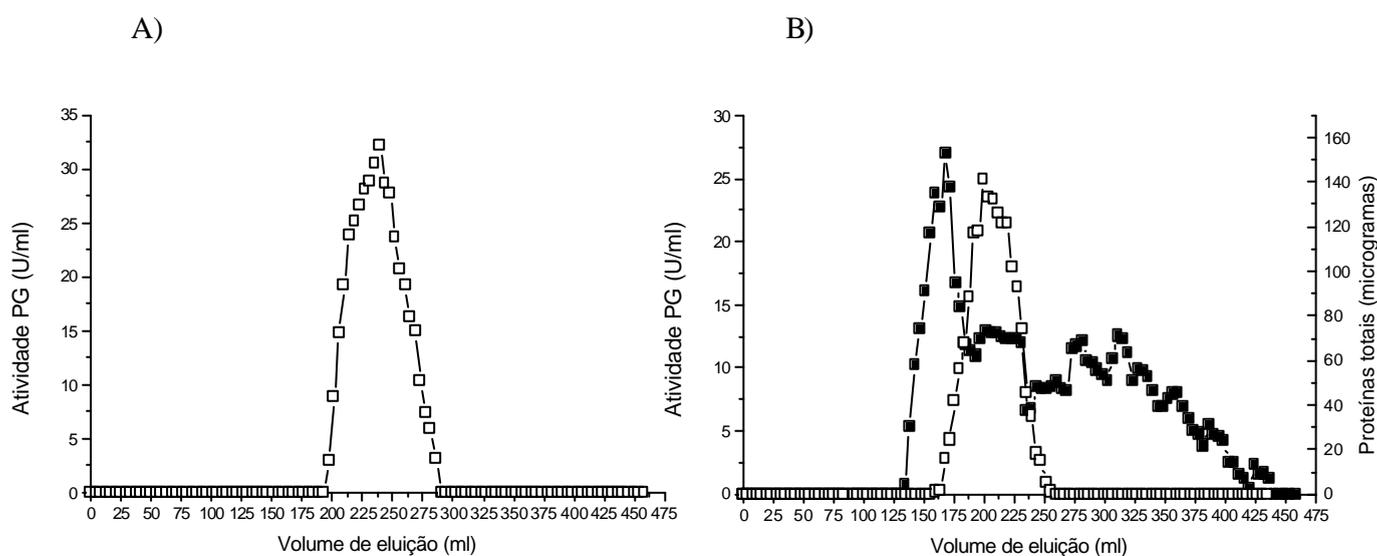
**Figura 12:** Perfil de eluição das poligalacturonases produzidas por *Thermoascus aurantiacus* aplicadas em coluna de cromatografia de filtração em gel, contendo gel Sephadex G75. **A-** Fermentação Submersa (FSM); **B-** Fermentação em Estado Sólido (FES). -□- Atividade PG; -■- Proteínas totais.
