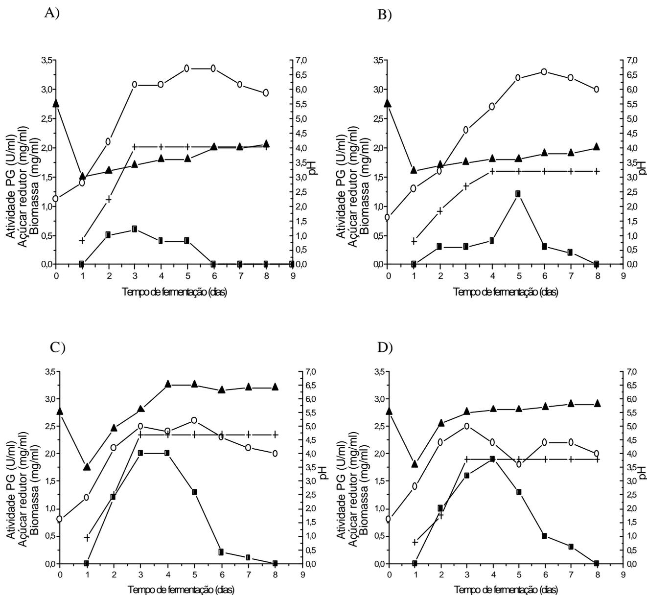
**Figura 4:** Produção de poligalacturonase pelo fungo *Thermoascus aurantiacus* através de FSM de diferentes meios de cultivo, com a pectina esterilizada separada do meio nutriente. **A-** Meio Czapek; **B-** Meio Khanna; **C-** Meio SR; **D-** Meio Vogel. -▲- Atividade de PG; -○- Açúcar redutor do meio do meio cultivo; -? - pH do meio de cultivo; -+ Biomassa fúngica. Valores expressos como média dos três experimentos.
