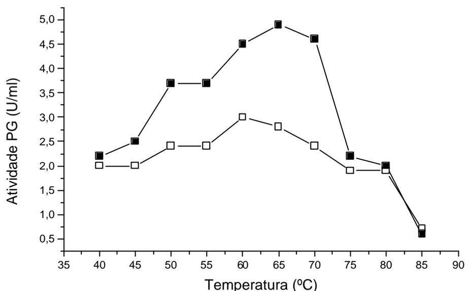
**Figura 9:** Efeito da temperatura sobre a atividade das pectinases brutas produzidas por *Thermoascus aurantiacus* através de FES em meio de 30% de bagaço de cana e 70% de laranja e em FSM na água amarela. -■- FES; -□- FSM.
