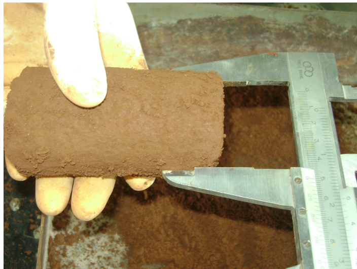
Figura 15 – Medida do diâmetro do corpo de prova com paquímetro
