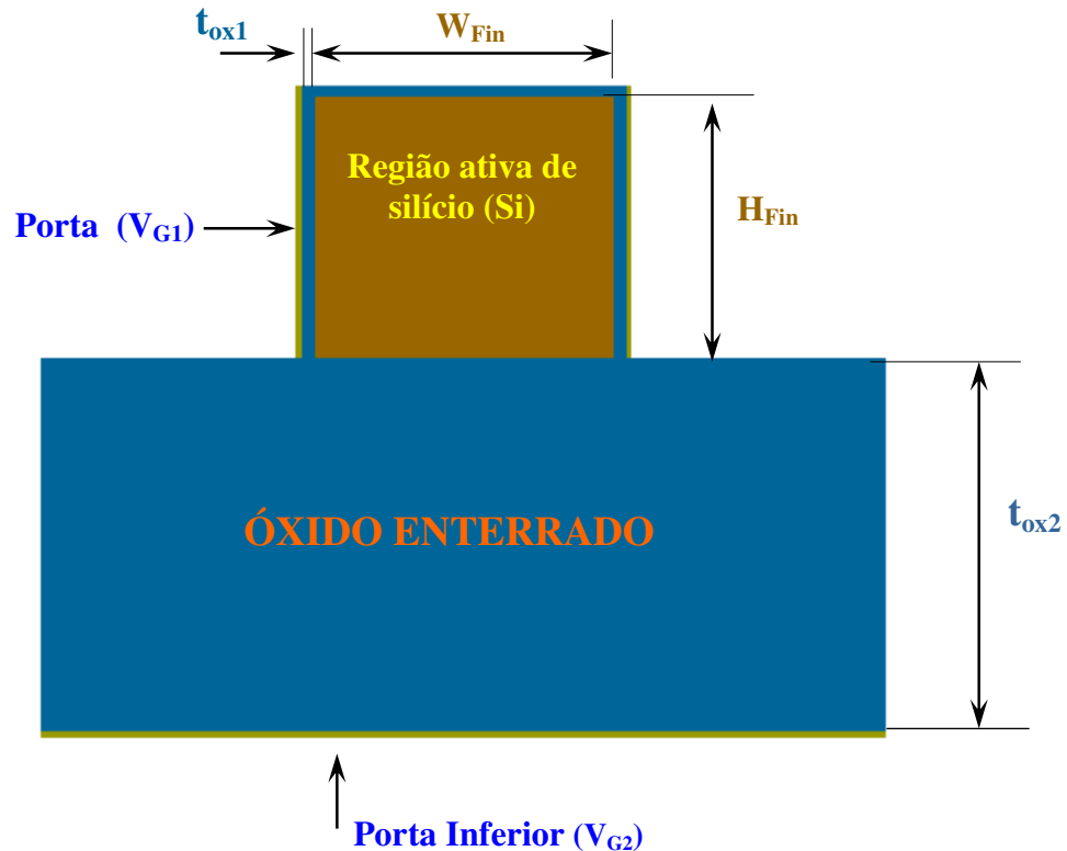
Fig. 5.6 - Seção transversal do dispositivo FinFET SOI de porta dupla com a indicação da altura do corpo de silício ( H_{Fin} ), largura do corpo de silício ( W_{Fin} ), espessura do óxido de porta ( t_{ox1} ), espessura do óxido enterrado ( t_{ox2} ), porta ( V_{G1} ) e porta inferior ( V_{G2} ).
