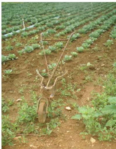
Foto 1 - Capinadeira tração animal e seu efeito na erradicação das plantas espontâneas e no revolvimento do solo (Mergulhão).
