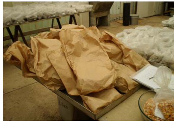
Foto 2 - Acondicionamento e identificação da sub-amostra em sacos de papel sobre uma bandeja de metal (MV).
