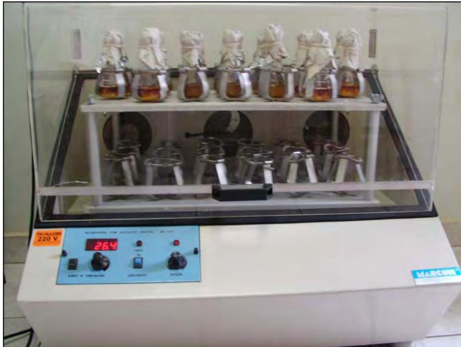
**Foto 9.** Ensaio em escala de frascos de 125mL em agitador orbital
