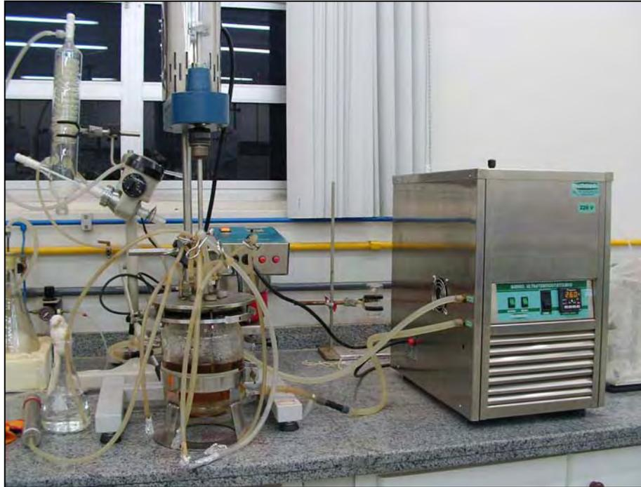
**Foto 1.** Montagem do biorreator
