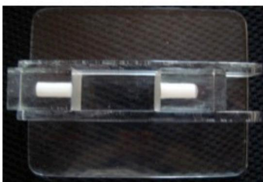
Figura 22c – Dispositivo para cimentação com CP
