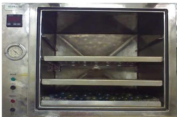
Figura 15 – “Secador de bandejas a vácuo”.
