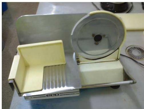
Figura 8 – “Cortador mecânico escolhido para fatiamento do gengibre”.
