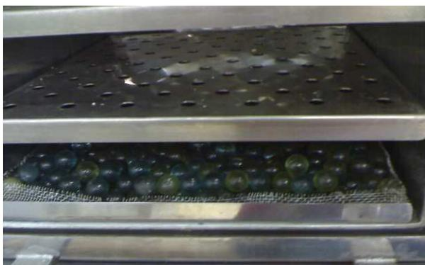
Figura 17 – “Disposição das esferas de vidro no interior do secador sob vácuo”.
