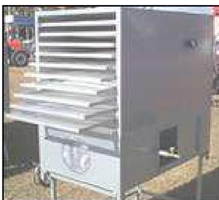
Figura 9 – “Secador de bandejas à pressão atmosférica (Meloni)”.
