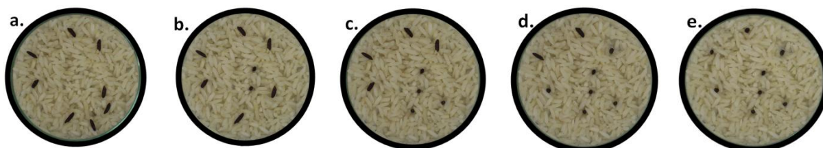
Figura 3.9. Amostra preparada de 1% de traçador para 0% (a), 25% (b), 50% (c), 75% (d) e 100% (e) de traçador em pé.
