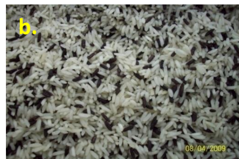
Figura 4.5. Experimento de mistura das partículas de arroz para 10 Kg de material carregado, 1RPM de frequência de rotação, em presença de tubos alimentadores e 10% de traçador (a. Fotografia do sistema depois de 9 giros; b. Vista da superfície das partículas).
