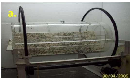
Figura 4.5. Experimento de mistura das partículas de arroz para 10 Kg de material carregado, 1RPM de frequência de rotação, em presença de tubos alimentadores e 10% de traçador (a. Fotografia do sistema depois de 9 giros; b. Vista da superfície das partículas).
