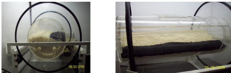
Figura 3.8. Condição inicial da técnica de traçadores coloridos (a. Vista frontal; b. Vista lateral).
