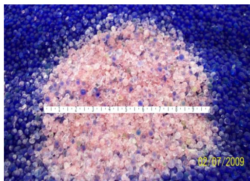
Figura 4.11. Área molhada da superfície do leito de sílica gel, para vazão de aspersão de 1500 mL/min.
