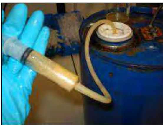
Figura 9. Biodigestor anaeróbico de alimentos do tipo “batelada” Extração do novo inóculo produzido.
