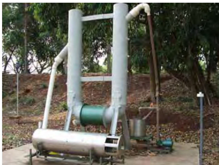
Figura 3. Biodigestor anaeróbico de alimentos utilizado para a produção do I.L.R.
