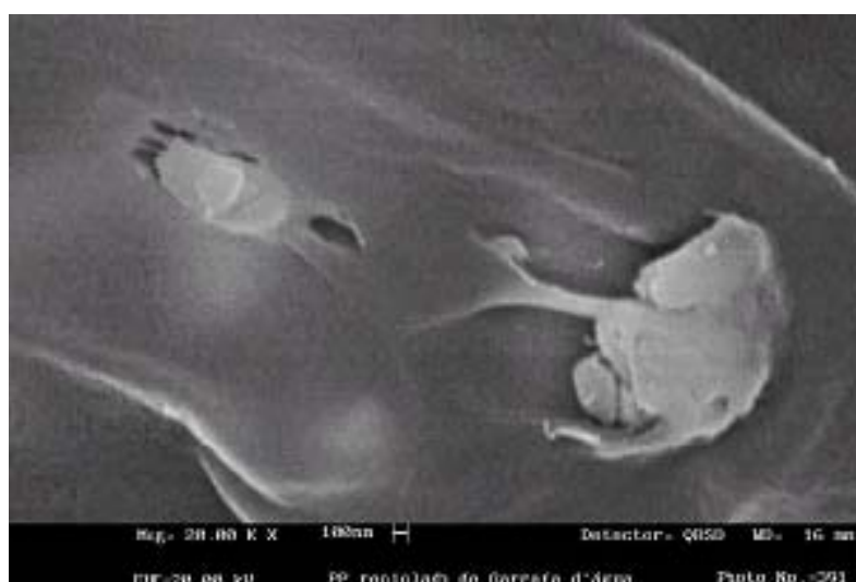
Figura 8 - Microcavitação em um papel sintético de polipropileno reciclado, através de espectroscopia por dispersão de energia (EDS) [23]
