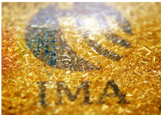
Figura 59 - Detalhe da tinta depositada na superfície do laminado 80-20
