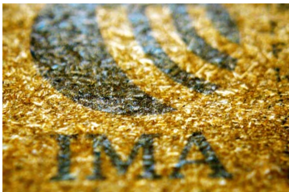
Figura 65- Detalhe da tinta depositada na superfície do laminado 50-50 reciclado
