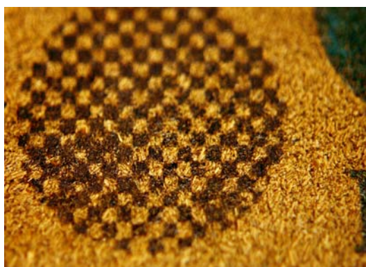
Figura 68 - Detalhe da tinta depositada na superfície do laminado 30-70
