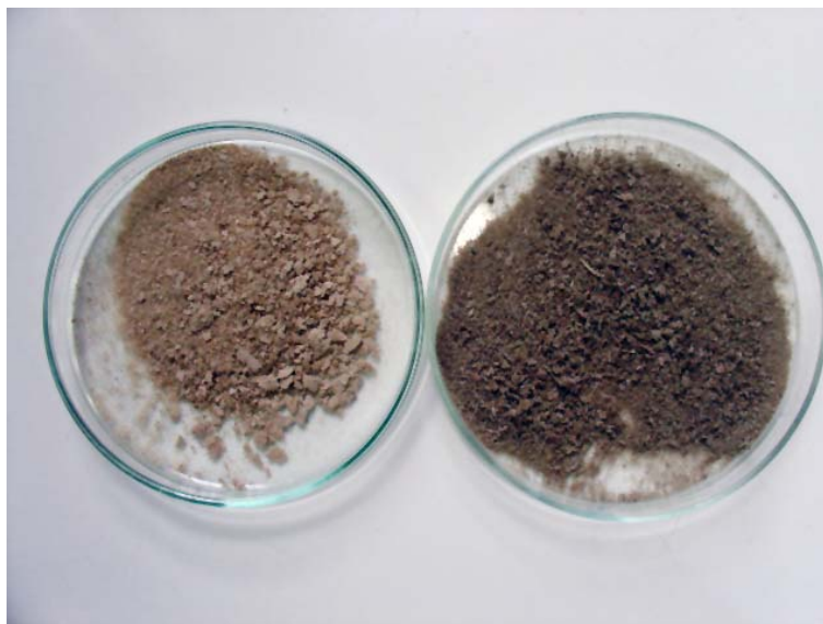
Figura 11 – Resíduo de bagaço de cana de menor dimensão, sendo à esquerda obtido com moinho de facas, e à direita obtido com liquidificador industrial
