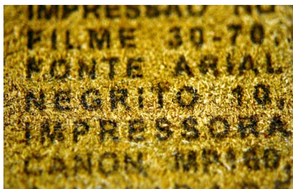
Figura 67 - Detalhe da tinta depositada na superfície do laminado 30-70
