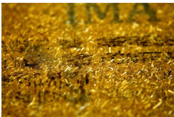
Figura 57 - Detalhe da tinta depositada na superfície do laminado 80-20
