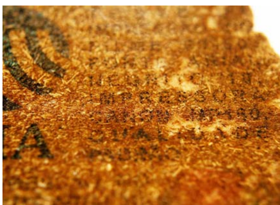
Figura 61 - Detalhe da tinta depositada na superfície do laminado 50-50 (texto)
