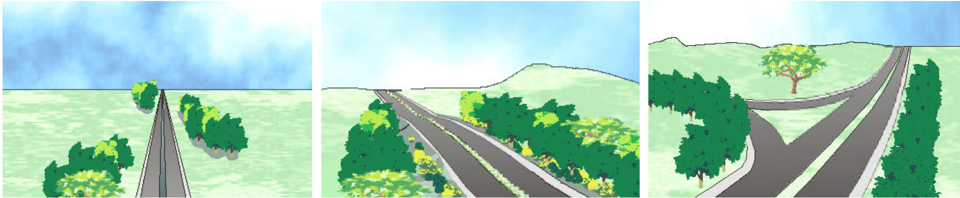
Figura 10: Três projetos tipo de paisagismo rodoviário recomendados pelo DNIT: projeto tipo 03 (quebra de monotonia em retas), projeto tipo 05 (curvas verticais acentuadas) e projeto tipo 08 (sinalização de acessos).
