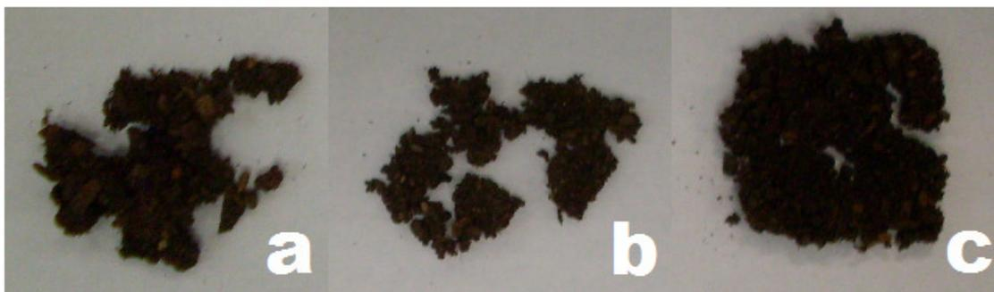
**Figura 50** – Fotos retiradas 10 dias após os filmes terem sido enterrados na terra, onde (a) amido: PVOH (30:70), (b) amido: PVOH (70:30) e (c) PVOH sozinho
