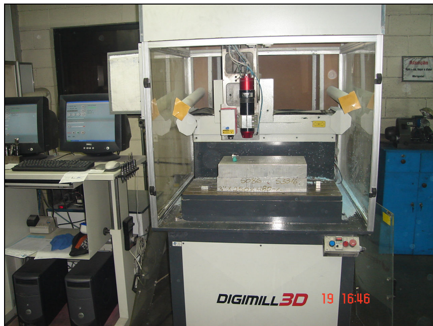
Figura 3. Processo de digitalização do dente no aparelho Digimill 3D (Tecnodrill®, Novo Hamburgo, Brasil)
