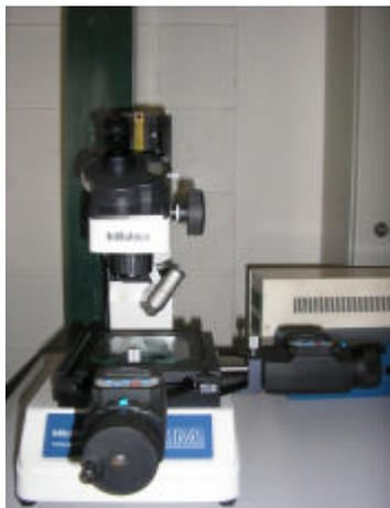
Figura 17: Microscópio Óptico
