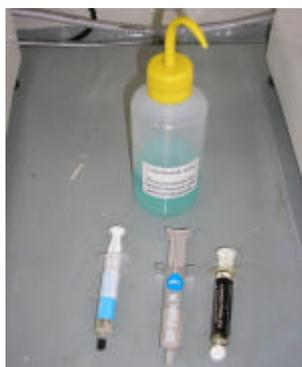
Figura 16: Pastas abrasivas e lubrificante.
